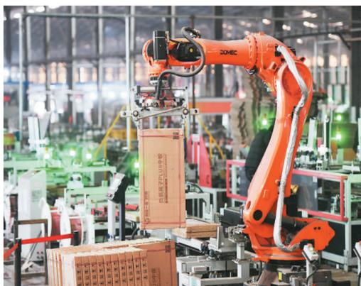
江西省高安市新景象陶瓷有限公司今年投入2.5亿元新增3条全自动智能化生产线,生产效率和产品质量均得到大幅提升。图为该公司全自动智能生产线在赶制瓷砖。
