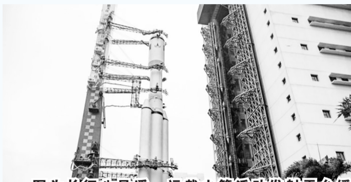
图为长征八号遥一运载火箭活动发射平台缓缓驶出垂直测试厂。
